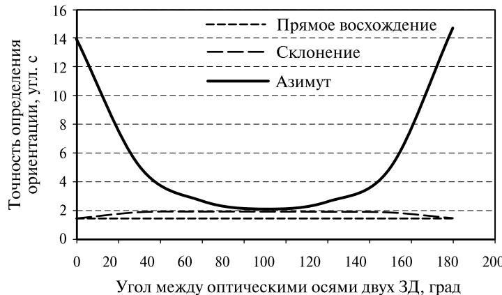
Рис. 3. Зависимость точности определения параметров ориентации от взаимного расположения приборов
