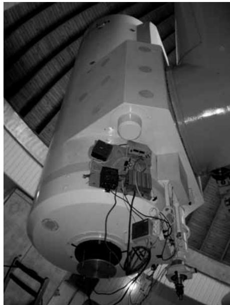
Рис. 1. Макет СДГ на телескопе Цейсс-1000
