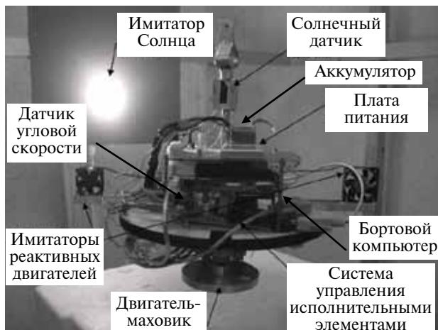
Рис. 5. Макет с гироскопическими элементами
