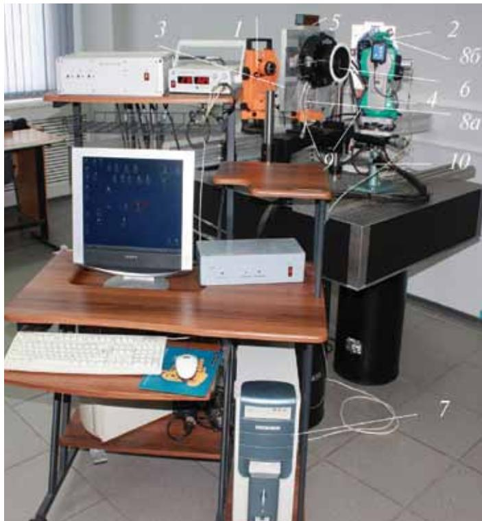
**Рис. 6.** Стенд наземной геометрической калибровки камер МСУ: 1 — контрольный теодолит; 2 — базовое зеркало; 3 — контрольное зеркало; 4 — измерительный теодолит; 5 — цилиндрический уровень; 6 — камера МСУ; 7 — контрольно-измерительная аппаратура МСУ; 8 — два имитатора (8а и 8б) посадочного места МСУ; 9 — два трегера; 10 — система горизонтальных и вертикальных перемещений измерительного теодолита
