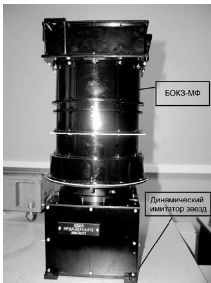
Рис. 14. Испытания звездного датчика на динамическом имитаторе
