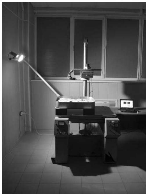
Рис. 1. Стенд моделирования стереоизображений шероховатых поверхностей
