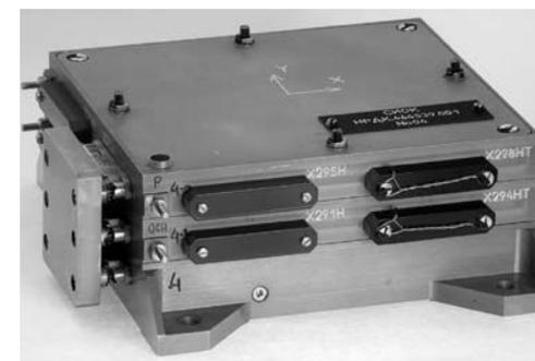
**Рис. 2.** Система информационного обеспечения комплекса научной аппаратуры (СИОК), штатный образец
